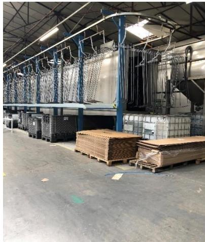
Figure 20 : Tunnel de dégraissage phosphatant
